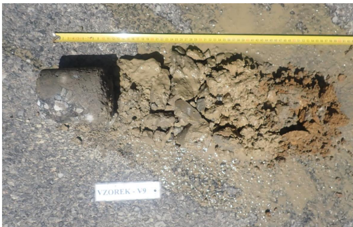
Obr. 17 - Jádro vývrtu Vzorek – V9 (in situ).
