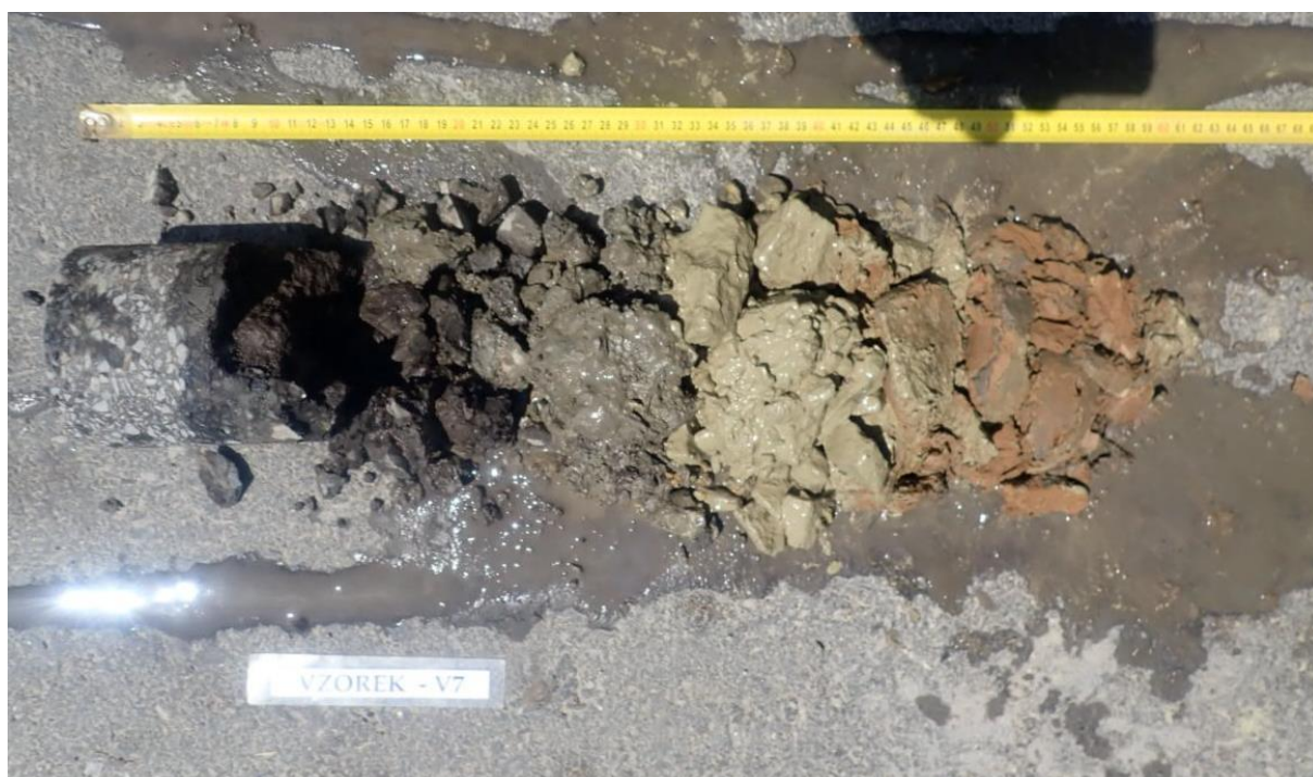
Obr. 13 - Jádru vývrtu Vzorek – V7 (in situ).
