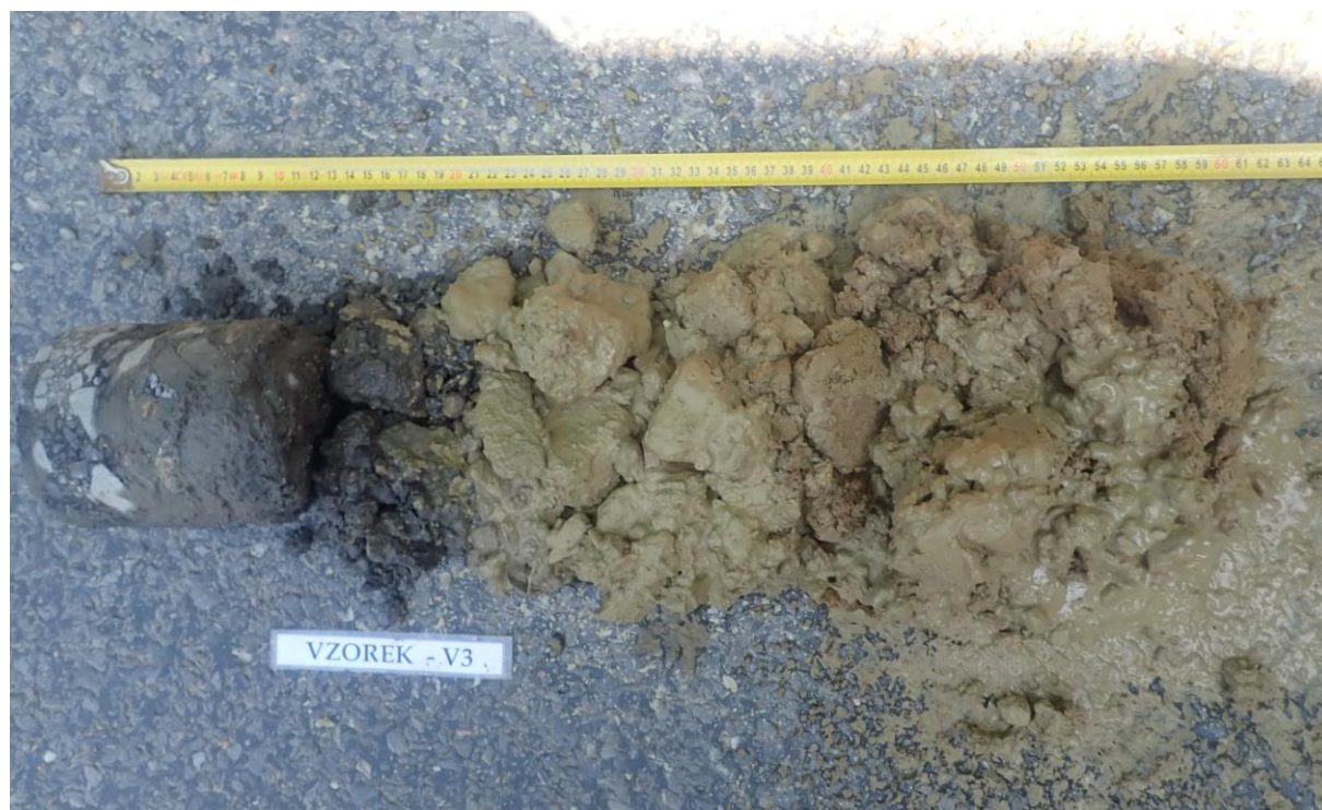
Obr. 5 - Jádro vývrtu Vzorek – V3 (in situ).
