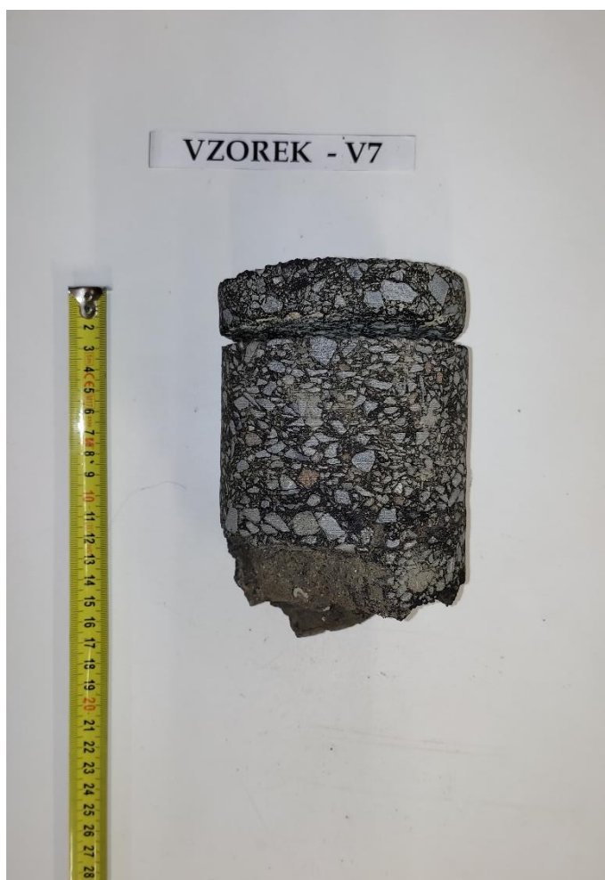
Obr. 14 - Jádro vývrtu Vzorek – V7 (laborať).
