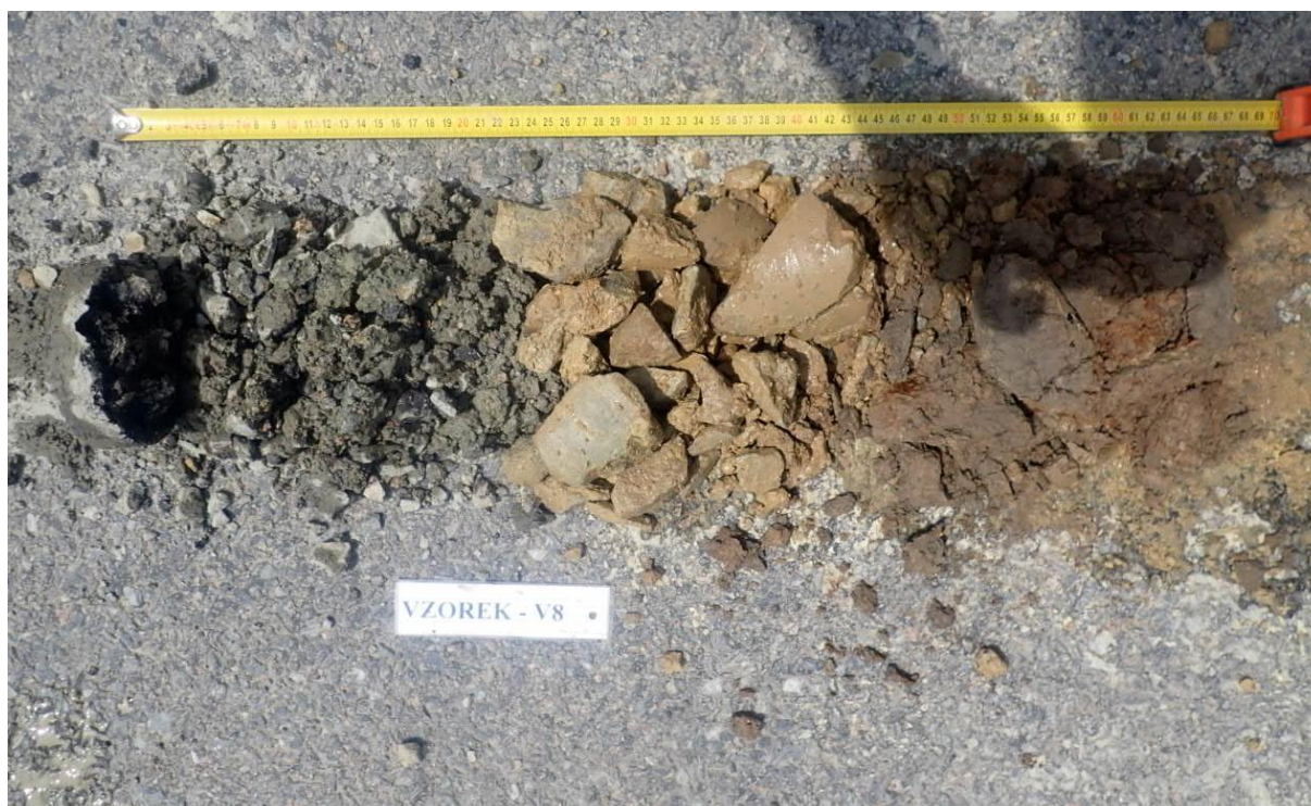
Obr. 15 - Jádro vývrtu Vzorek – V8 (in situ).
