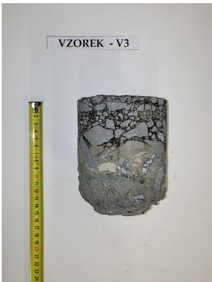
Obr. 6 - Jádru vývrtu Vzorek – V3 (laboratoř).
