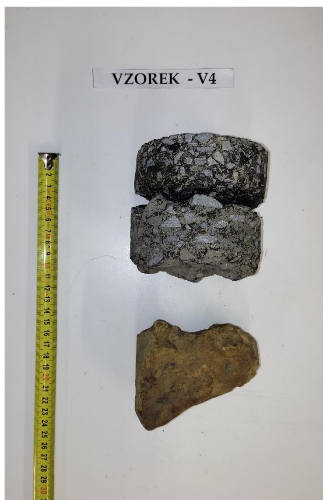
Obr. 8 - Jádru vývrtu Vzorek – V4 (laboratoř).
