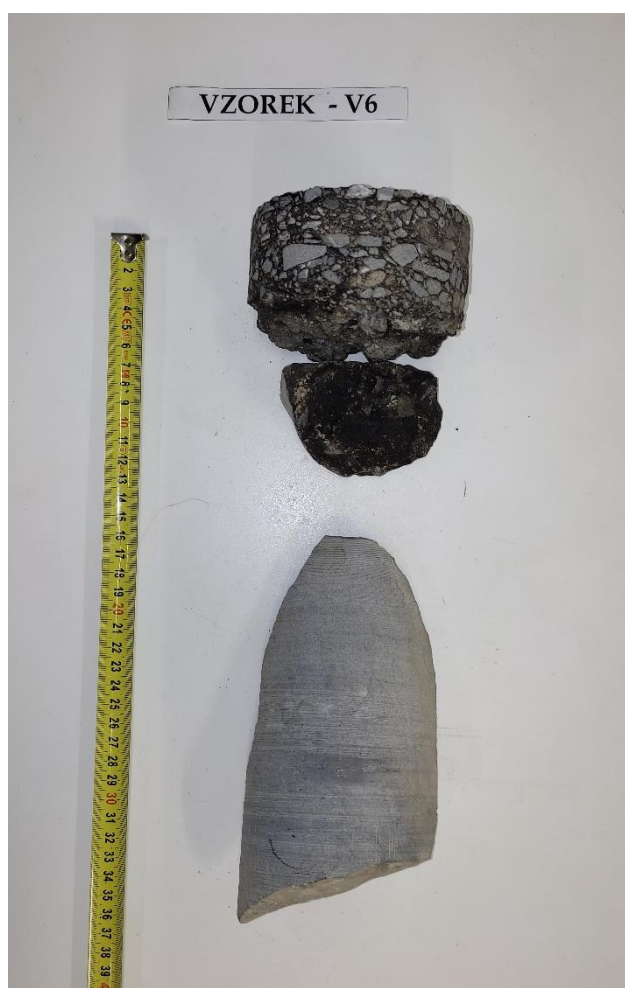
Obr. 12 - Jádro vývrtu Vzorek – V6 (laborať).
