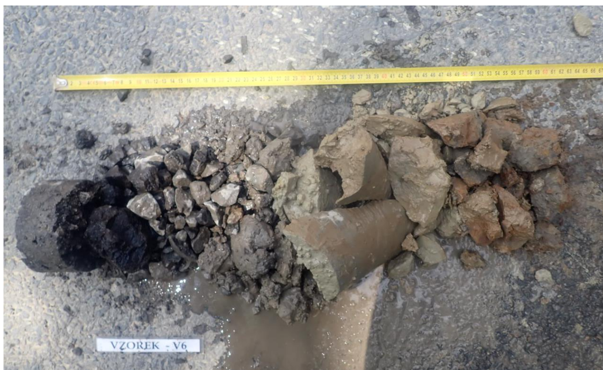
Obr. 11 - Jádru výtvaru Vzorek – V6 (in situ).
