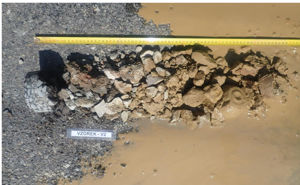
Obr. 3 - Jádro vývrtu Vzorek – V2 (in situ).
