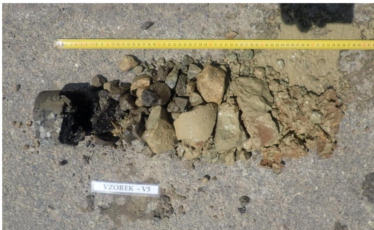
Obr. 9 - Jádro vývrtu Vzorek – V5 (in situ).
